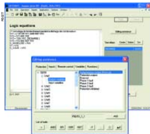
Пример экрана программного обеспечения SFT 2841: редактор логических уравнений
