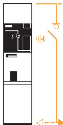
Ячейка с правым или левым шинным выводом IMB (375 мм)
